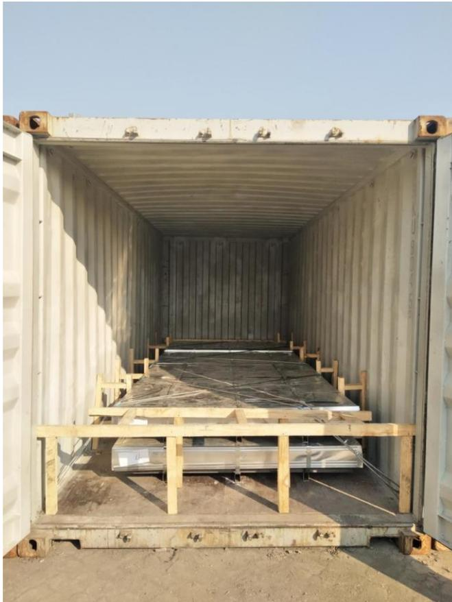
照片 4：在货物和箱门的之间必须要有木条支架以防止货物在运输过程中撞击箱门造成货物/集装箱损坏
