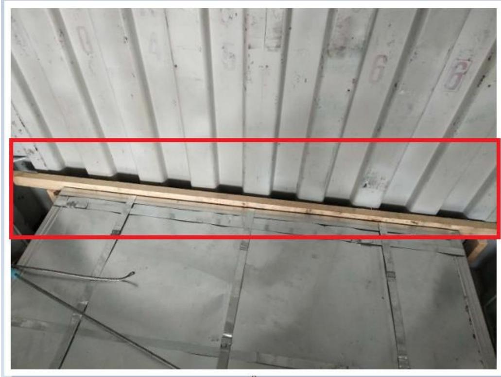
照片 2： 金属板两侧都需要由挡块/支撑体进行适当的固定；
