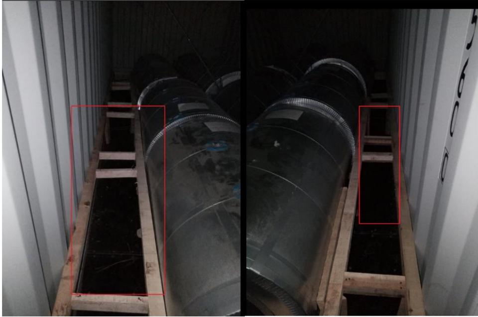
照片 3：集装箱内的处于最末位置的卷钢需以木条支架固定，不能碰触到集装箱墙面；
