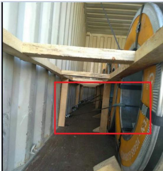
照片 5：在货物和箱门的之间必须要有木条支架以防止货物在运输过程中撞击箱门造成货物/集装箱损坏；
