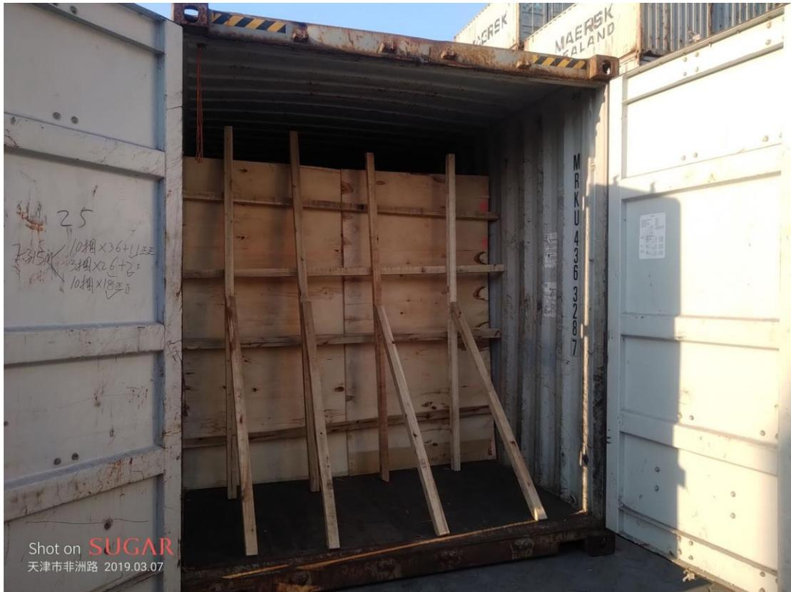
照片 5： 请提供 2 张关闭了一侧箱门的照片，需要同时显示出集装箱内的货物装载情况及集装箱箱号；这张图片一定要能看到里面的装载情况以及集装箱的边角。（一张需要清晰看到箱门与货物全貌；另一张需要看到箱门与加固了木条/木板后的全貌）
