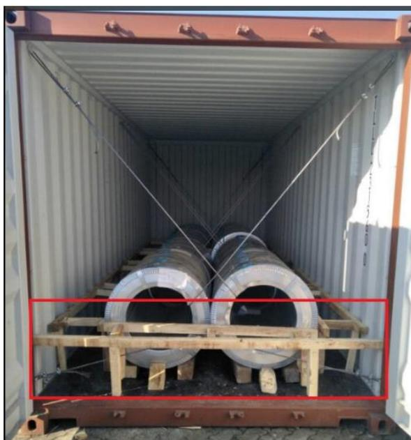
照片 6：请提供清晰的打开两侧箱门后的货物装载图片，请保证全部货物装载情况（货物，托盘，木条支架，钢丝绳是如何被固定的）都能一目了然；
