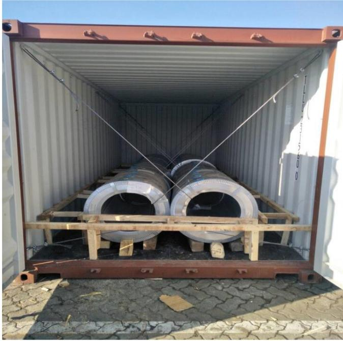
照片 7：请提供一张关闭了一侧箱门的照片，需要同时显示出集装箱内的货物装载情况及集装箱箱号；这张图片一定要能看到里面的装载情况以及集装箱的边角。
