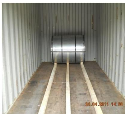
照片2: 卷钢两侧都需要由挡块/支撑体进行适当的固定;
