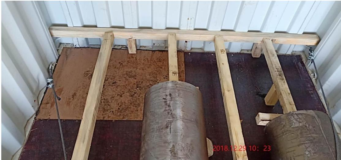
照片 4：在货物和箱门的之间必须要有木条/木板支架以防止货物在运输过程中撞击箱门造成货物/集装箱损坏；
